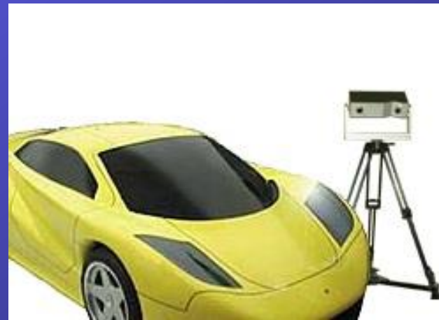
Triangulacioni skener na bazi strukturirane svetlosti COMET Steinbichler
